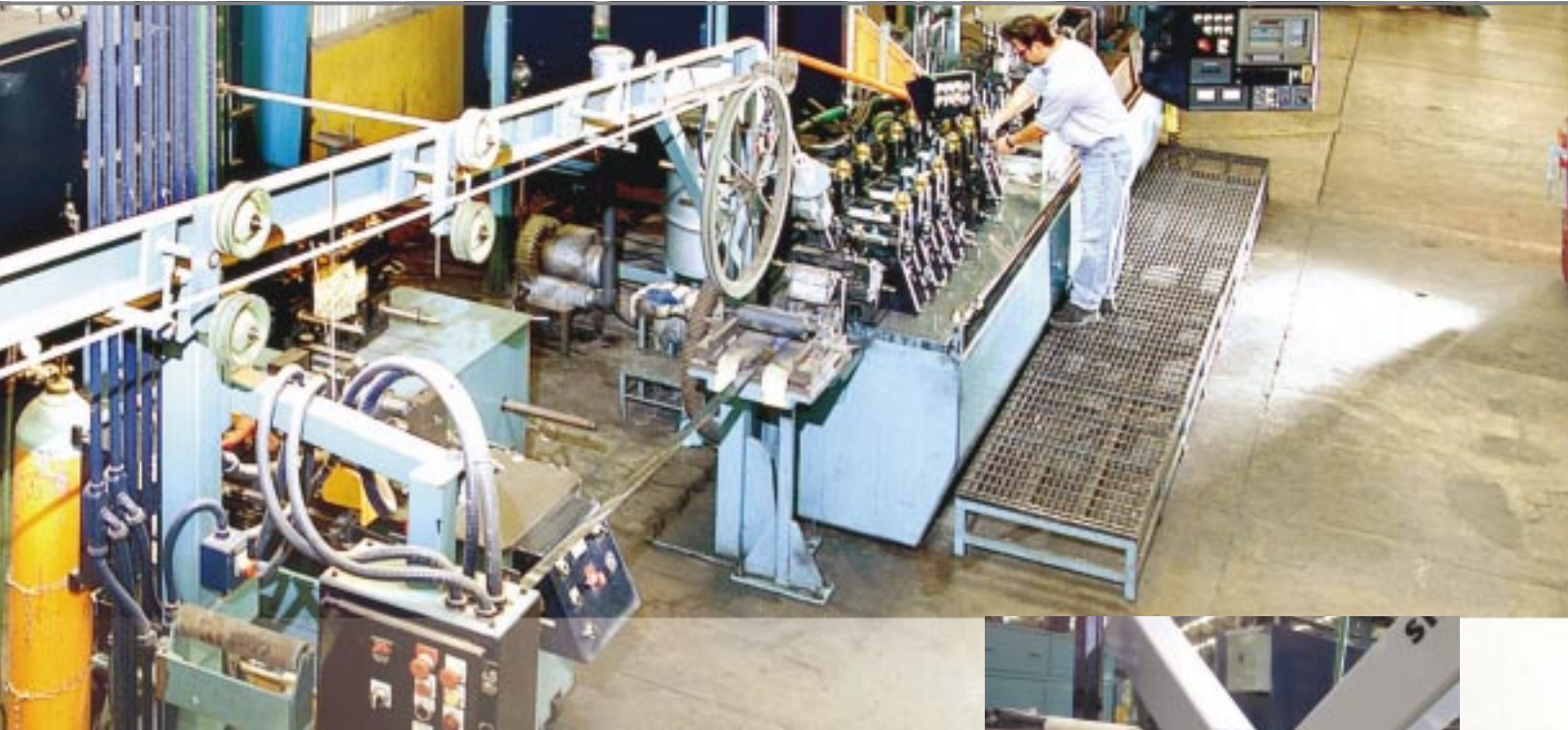
Línea de fabricación de cable coaxial troncal
