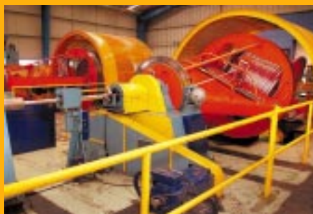
Fabricación de cables para cableado estructural categoría 6, y cables coaxiales y Rf para telefonía celular.
