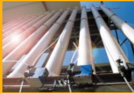
Columnas de lixiviación por contacto con soluciones ácidas o alcalinas.
