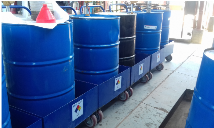
Acopio de Residuos Peligrosos en el proyecto de "Gasoducto Samalayuca-Sásabe"
